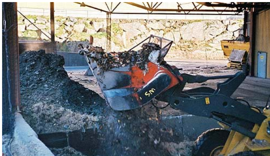
Figur 12: Bruk av Allu skuffe for å rive opp og blande matavfallet med struktur er vanlig i norske komposteringsanlegg.
