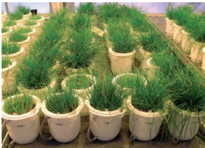
Forsøk med vannverksslam og avløpsslam i ulike blandingsforhold.
