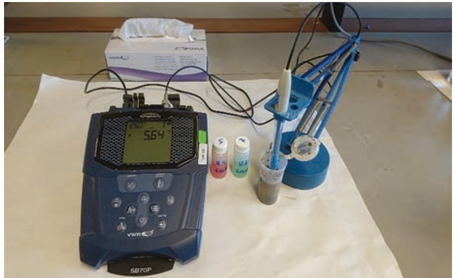
Figur 2. pH-meter med elektrode som viser måling i jord. Foto: Tore Krogstad
