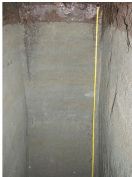
Figur 1. Jordprofil med utskiftede masser av grusholdig, siltig grovsand på Tiller.
