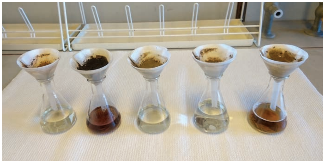
Figur 2. Ekstraksjon av jord med AL-løsning løser ut næringsstoffer og gir ekstraktene ulik farge. Foto: Tore Krogstad
