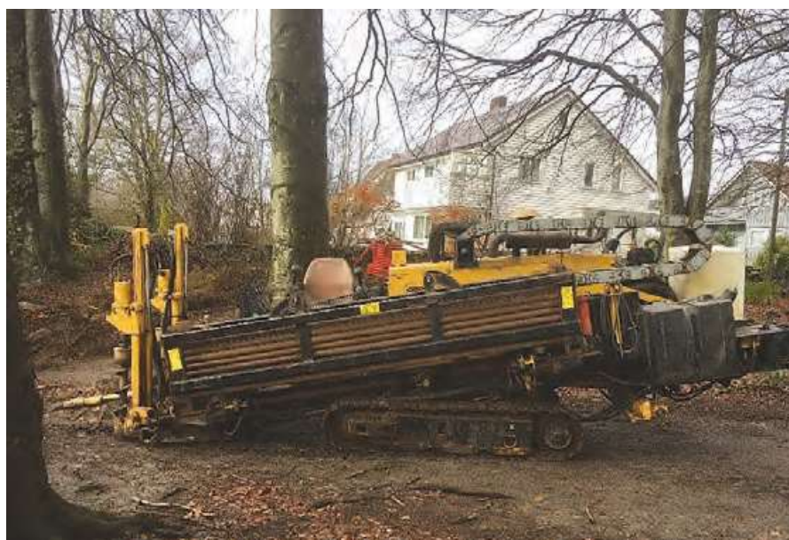
Figur 5. En maskin som kan bore eller presse rør med diameter 10 cm. Den blir drevet av én mann og kan enkelt transporteres med en tilhenger eller lett lastebil. Det tar 45 minutter å bytte hodet fra pressing til boring, dersom grunnforholdene krever dette. I bakgrunnen står noen trær i kanten av Gamle Mosvannsparken. Foto: Jose Gonzalez Plaza
