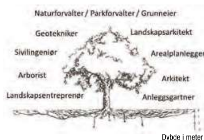
Figur 4. Å bevare verdifulle trær i bymiljø krever velvilje, tverrfaglig samarbeid og et felles mål. Legg spesielt merke til dybden på rotsystemet. Hos de fleste gamle trær er påleroten gått tapt eller den er redusert i størrelse. Opptil 80 prosent av røttene finnes i den øverste meteren av jorda. Illustrasjon modifisert fra Harris et. al. (2004) og Matheny et al. (1998)
