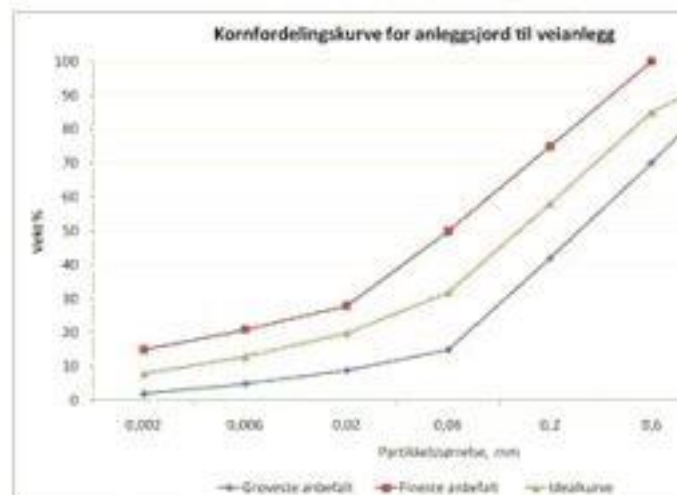
Figur 74.2 Anbefalt kornfordeling til mineraljord
